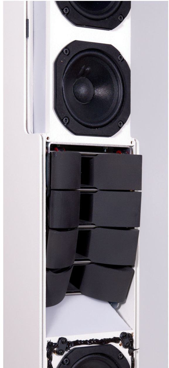
Hochtoneinheit als Mini Line-Array mit mechanisch einstellbarem Öffnungswinkel von 5°, 15° oder 25° (Foto eines Prototypenmusters)
