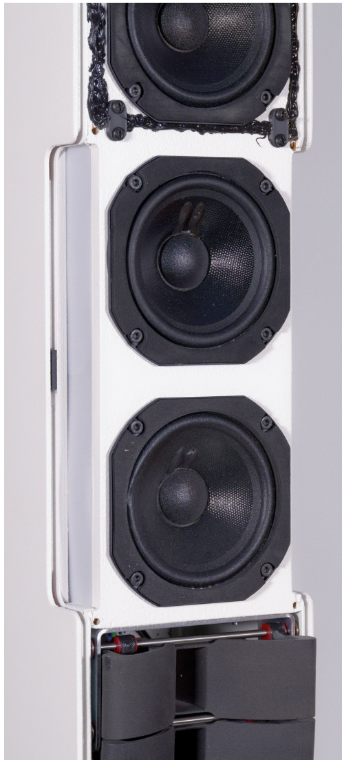
Mitteltöner mit seitlicher Abstrahlung von dessen Rückseite durch eine Schicht Basotect. Damit wird ein cardioides Abstrahlverhalten erreicht (Foto eines Prototypenmusters)
