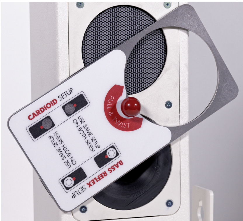
Bassreflexsystem oder Cardioid Drehbare Abdeckplatte auf der Rückseite zu Wahl des Betriebsmodus für die Tieftöner
